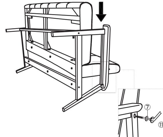
04 ④フロントレールと②座部を、⑥ネジAで2箇所、
