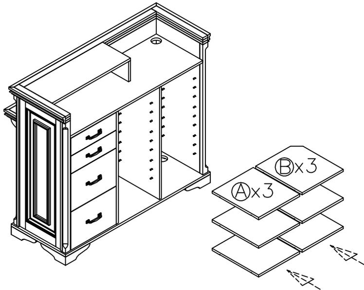
③引き出しの内側に取り付けてある取っ手を外側に付け替えて下さい。
